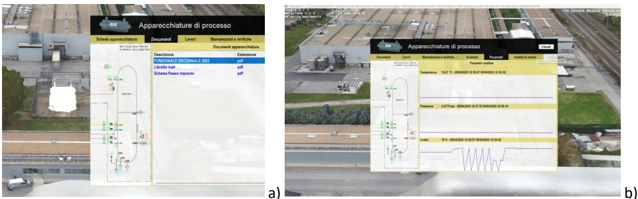
Figura 27 Esempio di interfaccia grafica e scheda dell’apparecchiatura, in cui si mostrano schede apparecchi (a) i parametri di processo in tempo reale (b).
